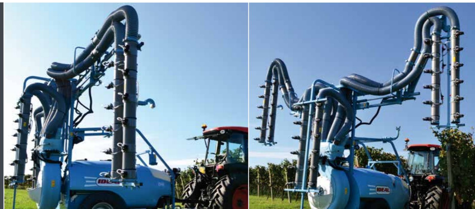
Barra parallelogramma 3 file complete 6 calate/6 flap / Parallelogram boom for 3 complete rows 6 drop arms/6 flaps / Rampe parallélogramme face par face 6 descentes/6 ailes Parallelogrammbalken 3 komplette Reihen 6 Sprüharme/6 Flap / Barras con movimiento paralelogramo para el tratamiento de 3 hileras completa 6 pendiente / 6 flap
